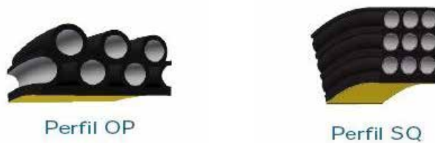
Figura 7.1-7: Perfiles KRAH® de los tipo OP y SQ
