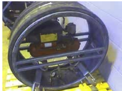
Foto 5.6-1: Dispositivo prueba junta por junta
