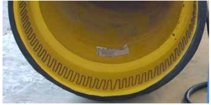
Foto 5.3-2: Resistencia eléctrica incorporada en la Campana
