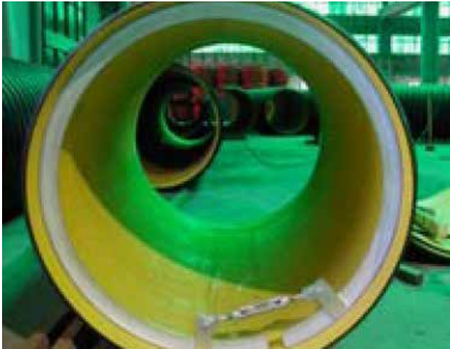
Foto 5.3-3: Electrofundición de tuberías KRAH®. Vista Fleje interno/Aro rigidizador
