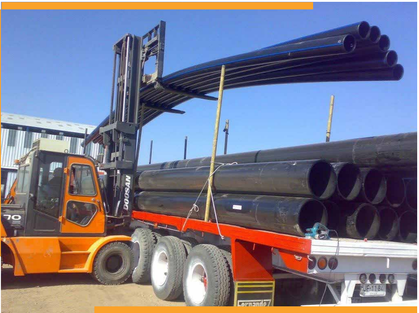
Foto 2.1 Tubería KRAH® PE 100
